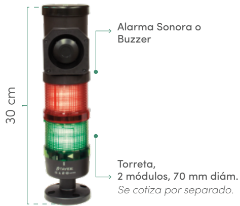
TORRETA 2 MÓDULOS CON BUZZER
